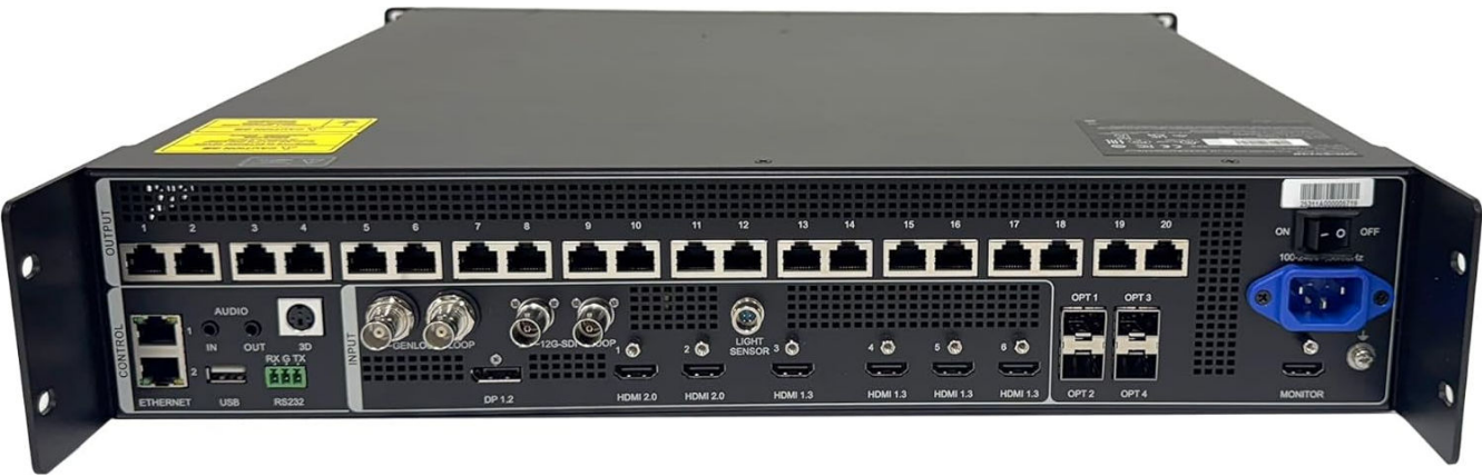
Face arrière : 20 ports Gigabit Ethernet, 4 ports fibre 10G, entrées DP 1.2, HDMI 2.0 ×2, HDMI 1.3 ×4 et 12G-SDI, Genlock, capteur de luminosité et sortie moniteur.
